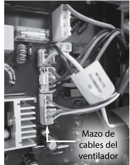
Figura 96 - Ubique el mazo de cables del ventilador en la placa de control.
