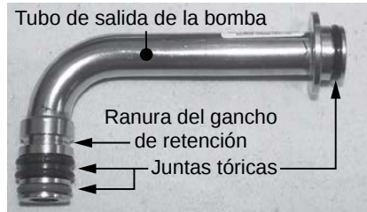
Figura 186 - Juntas tóricas del tubo de salida de la bomba.
