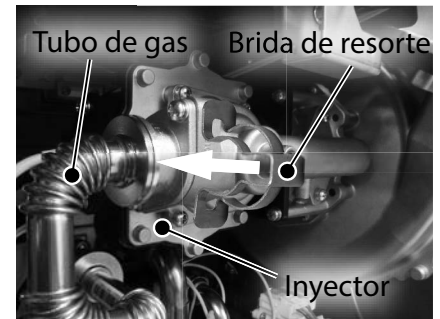
Figura 101 - Fije la brida de resorte superior.
