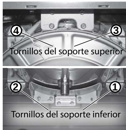
Figura 146 - Ubique y retire los tornillos del soporte del intercambiador de calor.
