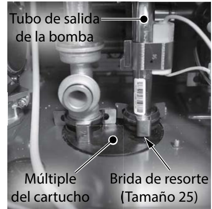
Figura 248 - Retire la brida de resorte del tubo de salida de la bomba.
