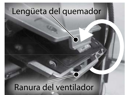
Figura 127 - Lengüeta del quemador y ranura del ventilador.
