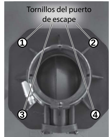
Figura 147 - Retire los tornillos del puerto de escape.
