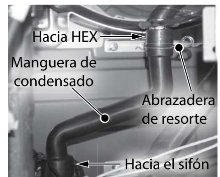
Figura 135 - Desconecte la manguera de condensado.
