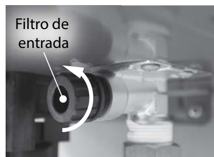
Figura 245 - Ubique y retire el filtro de entrada.
