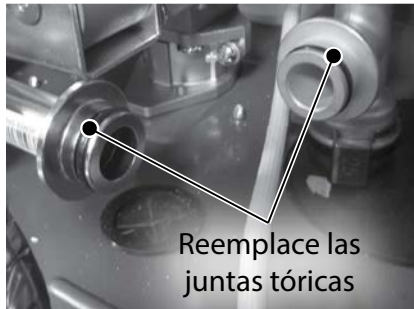
Figura 214 - Reemplace las juntas tóricas expuestas.
