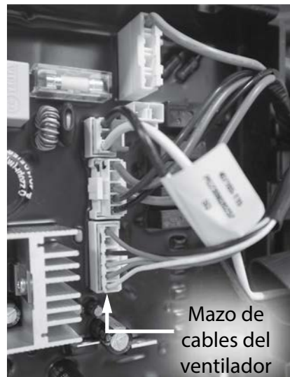
Figura 130 - Ubique el mazo de cables del ventilador en la placa de control.
