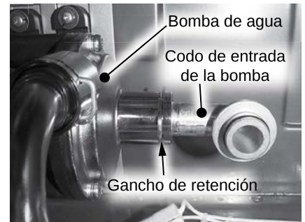
Figura 167 - Ubicación del codo de entrada de la bomba.
