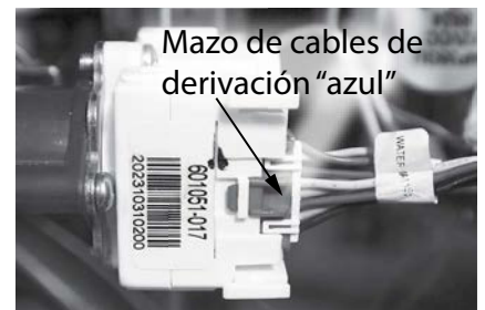
Figura 55 - Ubicación del mazo de cables de la válvula de derivación.
