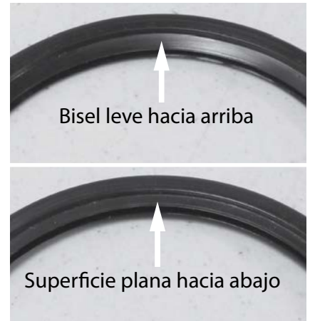
Figura 152 - Oriente la junta de escape.
