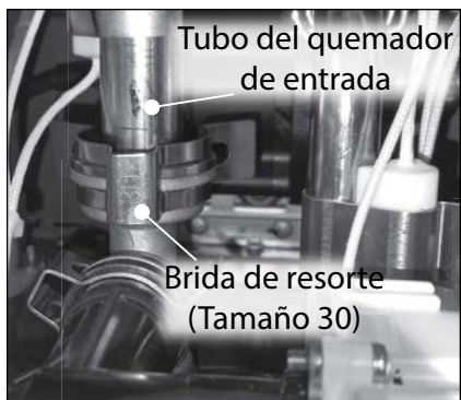
Figura 255 - Brida de resorte (tamaño 30), tubo de entrada del quemador (A3).
