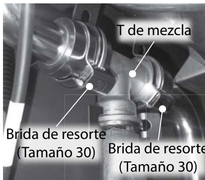
Figura 205 - Retire las bridas de resorte del tubo de salida HEX y el tubo de agua de salida.
