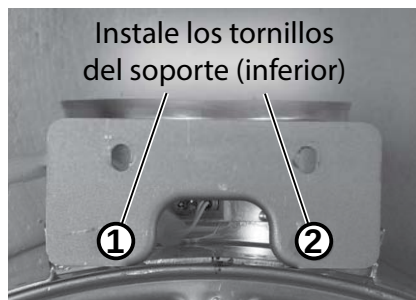
Figura 151 - Soporte de instalación del intercambiador de calor.
