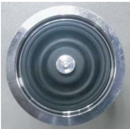
Figura 10 - Alineación incorrecta del pilar de aluminio y el diafragma.
