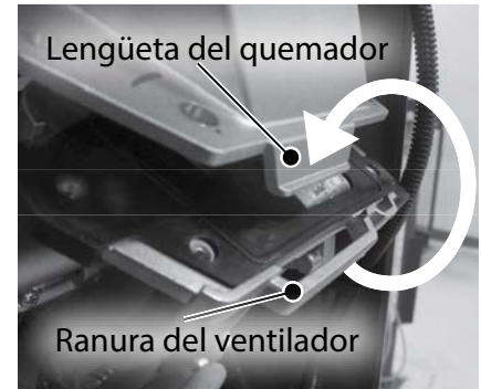
Figura 110 - Lengüeta del quemador y ranura del ventilador.
