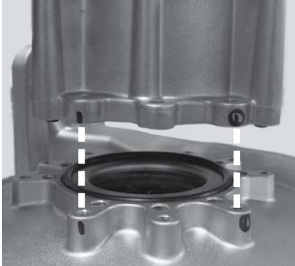
Figura 93 - Alineación correcta del ventilador y el inyector.
