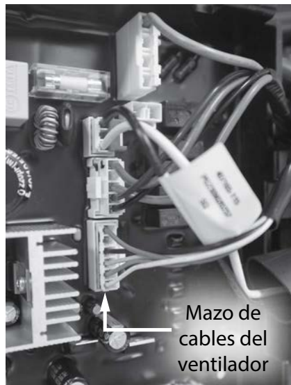
Figura 85 - Ubique el mazo de cables del ventilador en la placa de control.
