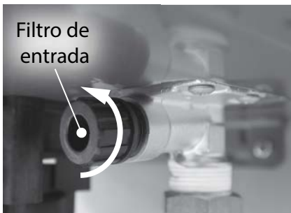
Figura 177 - Ubique y retire el filtro de entrada.
