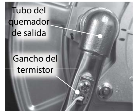
Figura 265 - Gancho del termistor, tubo de salida del quemador.
