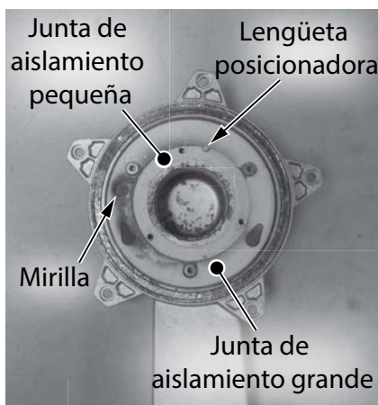
Figura 123 - Juntas de aislamiento del quemador.
