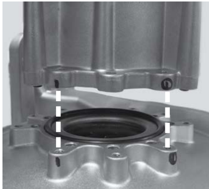
Figura 107 - Alineación adecuada del inyector y el ventilador.
