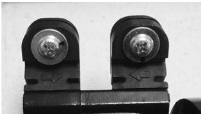
Figura 172 - Orientación de la funda de junta de la bomba de agua.
