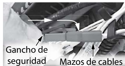
Figura 39 - Fije el cableado con un gancho de seguridad.
