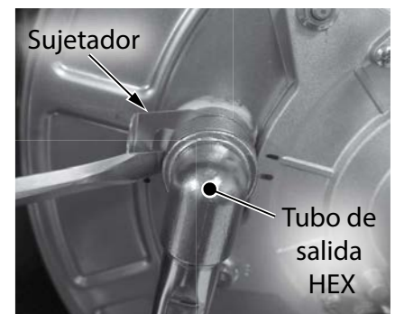
Figura 140 - Retire el sujetador que fija el tubo de salida HEX.
