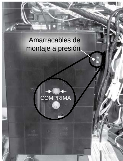
Figura 50 - Ubicación del conector de montaje a presión.
