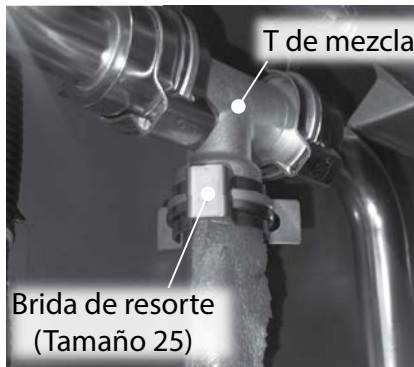
Figura 204 - Retire la brida de resorte que fija el tubo de agua de derivación.
