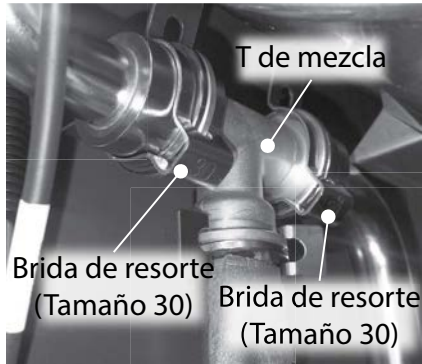
Figura 253 - Bridas de resorte (tamaño 30), T de mezcla (A1).
