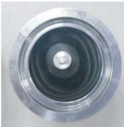
Figura 10 - Alineación incorrecta del pilar de aluminio y el diafragma.
