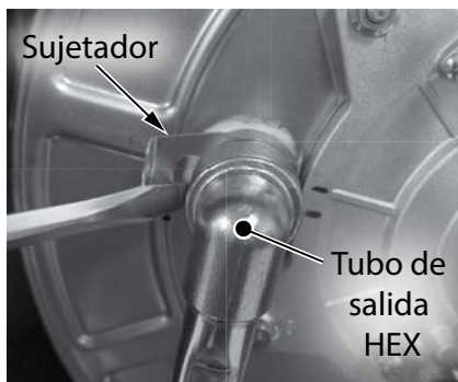
Figura 200 - Retire el sujetador que fija el tubo de salida HEX.
