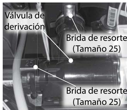
Figura 257 - Bridas de resorte (tamaño 25), válvula de derivación (B2).
