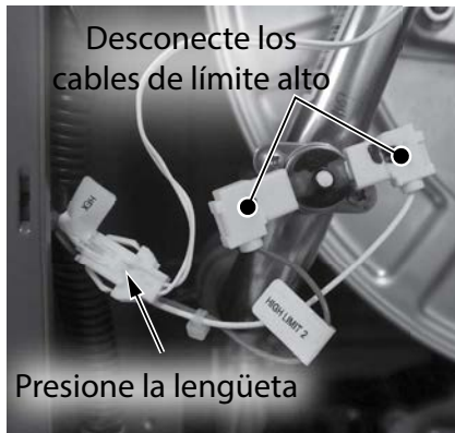
Figura 141 - Desconecte el cableado del tubo de salida HEX.
