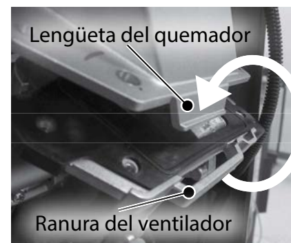
Figura 158 - Lengüeta del quemador y ranura del ventilador.
