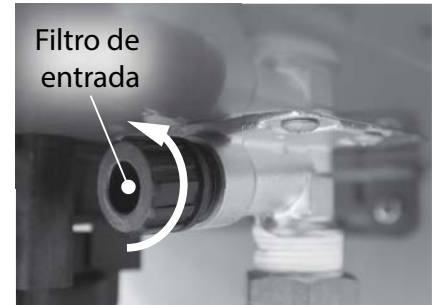
Figura 202 - Ubique y retire el filtro de entrada.
