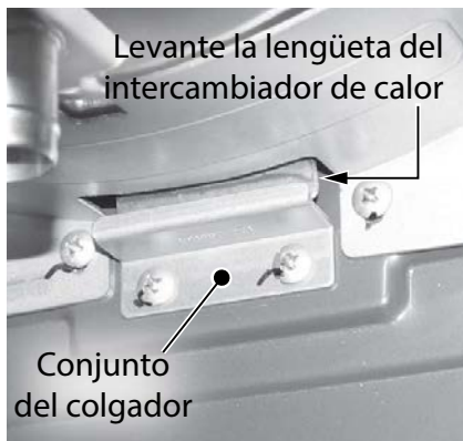
Figura 149 - Lengüeta del intercambiador de calor y colgador (lado inferior del intercambiador de calor).
