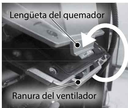
Figura 94 - Lengüeta del quemador y ranura del ventilador.
