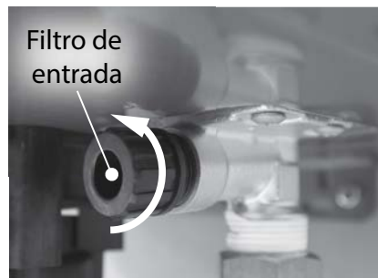
Figura 161 - Ubique y retire el filtro de entrada.
