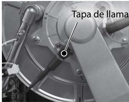
Figura 74 - Retire la tapa del sensor de llama.
