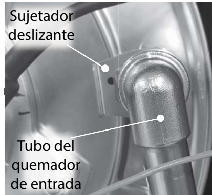
Figura 262 - Sujetador deslizante, tubo de entrada del quemador.
