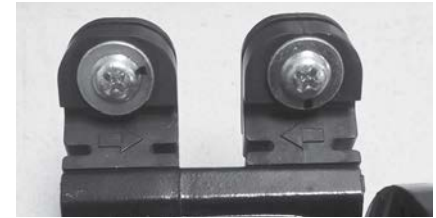
Figura 188 - Orientación de la funda de junta de la bomba de agua.
