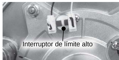
Figura 118 - Ubicación del límite alto de la puerta del quemador.
