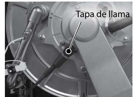
Figura 42 - Retire la tapa del sensor de llama.
