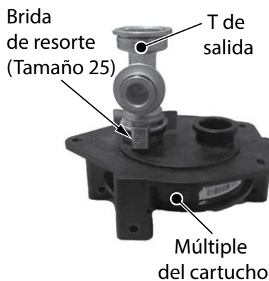
Figura 250 - Retire la brida de resorte de la T de salida y del múltiple del cartucho.
