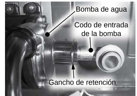
Figura 183 - Ubicación del codo de entrada de la bomba.
