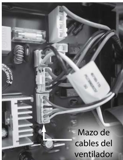
Figura 111 - Ubique el mazo de cables del ventilador en la placa de control.
