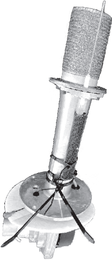
Figure 14. Souffleur d'air de combustion pour modèle 50 gallons
